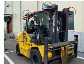
フォークリフトのカメラ設置状況
