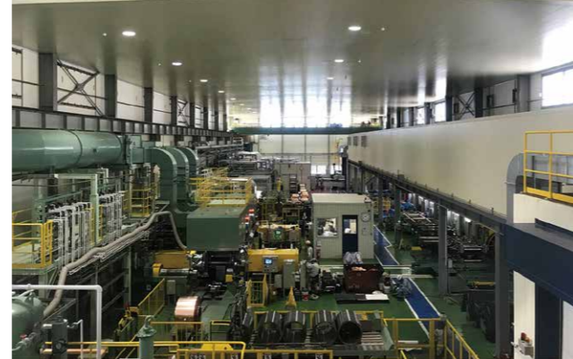
圧延銅箔および高機能銅合金条の圧延機(当社倉見工場)
